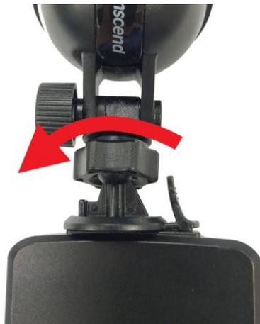
5. DrivePro の位置が決まったら、調節ノブを時計回りに回して固定します。その場所に DrivePro がしっかりと安全に固定されていることをご確認ください。
