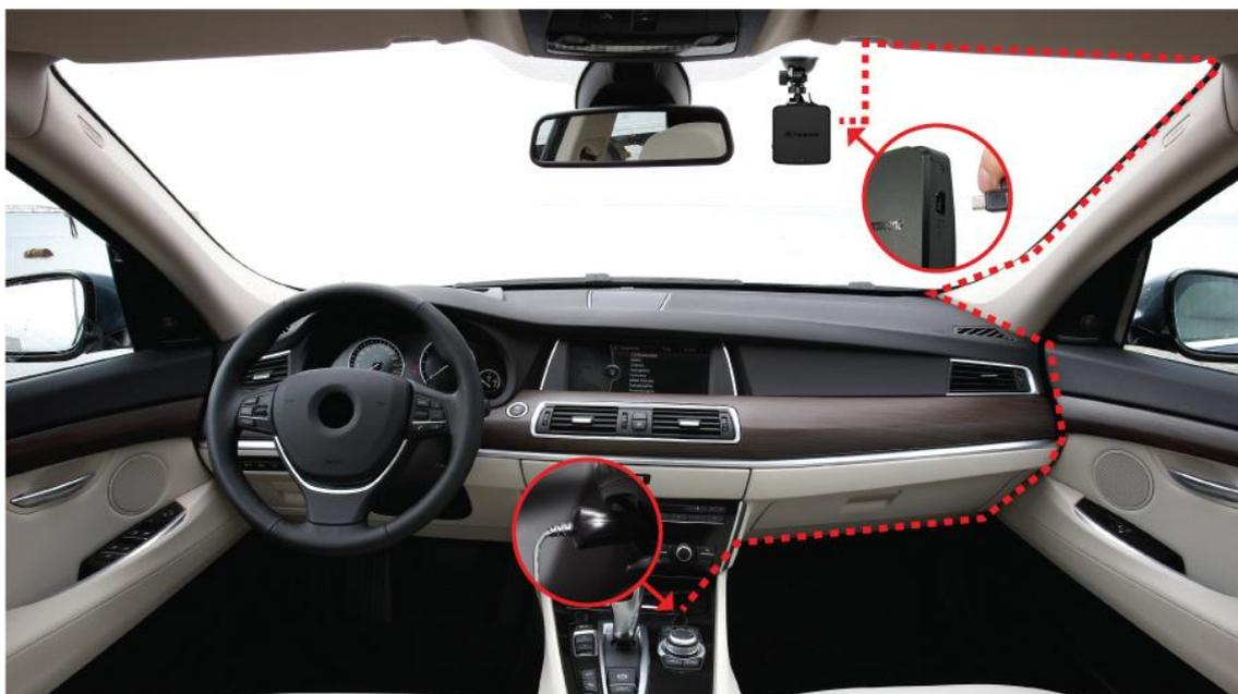
1. カーアダプタのミニ USB 端子を DrivePro の USB ポートに接続します。
